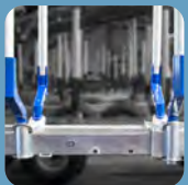
Teleskopierbarer Rahmen, verschiebbar nach der 1. Rungenbank (ausgefahren)
