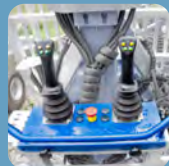
Hydr. Vorsteuerung mit E-Funktion
