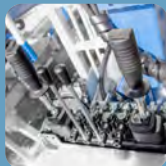
Mech. Kreuzhebelsteuerung mit E-Funktion geschlossen
