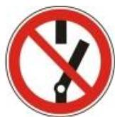
Schwere Verletzungsgefahr durch Einschalten des Antriebs bei Störfällen!
